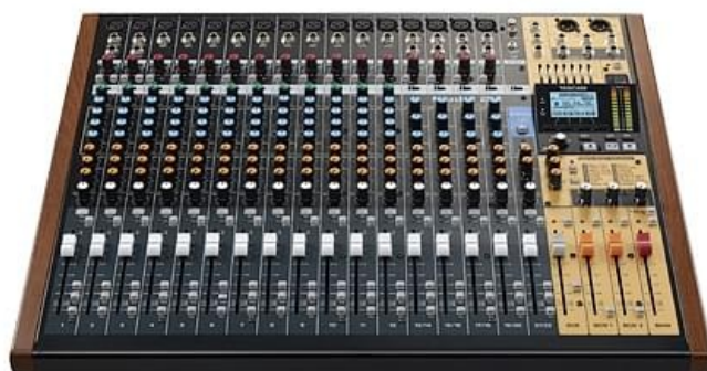
Model 24: Mélangeur analogique 22 canaux avec enregistreur numérique 24 pistes
