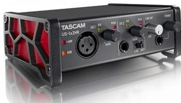
US-1x2HR: Interface audio USB haute résolution (2 entrées / 1 micro, 2 sorties)
