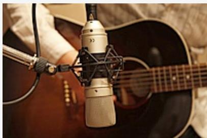
Placez un microphone à environ 20 cm de la rosace de la guitare (le trou dans la table d'harmonie). Ce micro est le «micro de proximité». Vérifiez que la membrane du microphone est parallèle à la table d'harmonie de la guitare. Si le son est trop confus dans les graves, déplacez le microphone depuis la rosace vers la tête.
