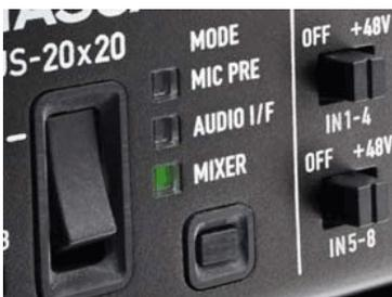
D'une grande polyvalence, l'US-20x20 est à la fois une interface pour enregistrement multipiste (utilisée conjointement avec un ordinateur personnel et un logiciel de station de travail audio), un préampli micro autonome ou un mixeur utilisable en concert.
