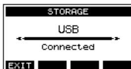
Auf dem Computer erscheint das Model 12 als Wechsel Datenträger mit der Bezeichnung „TASCAM\_M“ (sofern die Speicherkarte auf diesem Gerät formatiert wurde).
