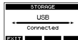
Auf dem Computer erscheint das Model 24 als Wechseldatenträger mit der Bezeichnung „TASCAM\_M“ (sofern die Speicherkarte auf diesem Gerät formatiert wurde).
