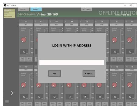
Utilisez cette fonction si la détection n'est pas possible avec le protocole multicast UPnP parce que, par exemple, l'adressage (Adressing) est réglé sur STATIC (DHCP désactivé) dans la fenêtre NETWORK SETTINGS de la page SETTINGS et que les appareils se trouvent sur des segments de réseau différents.
