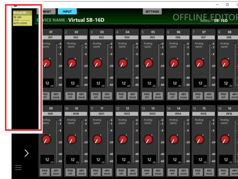
Si plusieurs SB-16D sont connectés par réseau local (LAN), ils apparaîtront tous dans la zone de navigation des appareils.
