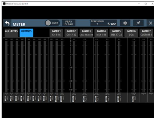
Tippen Sie auf die Zurück- oder Schließen-Schaltfläche, um zur normalen Ansicht zurückzukehren. Sie können auch dieselben Bedienschritte wie auf dem Mischpult selbst ausführen, um zur normalen Ansicht zurückzukehren.
