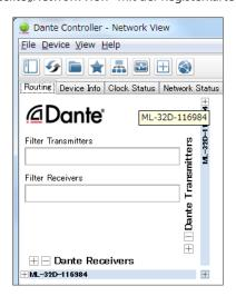
Wenn der Computer und das Dante-Gerät ordnungsgemäß angeschlossen sind, wird die Gerätebezeichnung angezeigt.
