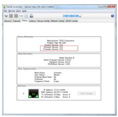
Die Versionsnummer wird an der unten rot markierten Stelle angezeigt. Wenn die installierte Version bereits dieselbe (oder eine höhere) Nummer als die Update-Version aufweist, ist keine Aktualisierung nötig.
