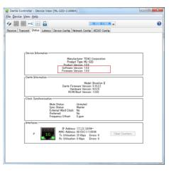
16. Klicken Sie auf die Registerkarte "Status", und vergewissern Sie sich, dass die neue Versionsnummer angezeigt wird. Damit ist die Aktualisierung abgeschlossen.
