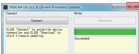
6. Nach der Aktualisierung müssen Sie das Interface einmal aus- und wieder einschalten, um es nutzen zu können. Ziehen Sie dazu bei einem US-2x2, das über USB mit Strom versorgt wird, das USB-Kabel heraus und stecken Sie es anschließend wieder ein.
