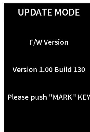
3. Drücken Sie die Taste MARK, um die aktuelle Version und Build-Nummer des Geräts sowie die Version und Build-Nummer der Aktualisierungsdatei auf der SD-Karte anzuzeigen.
