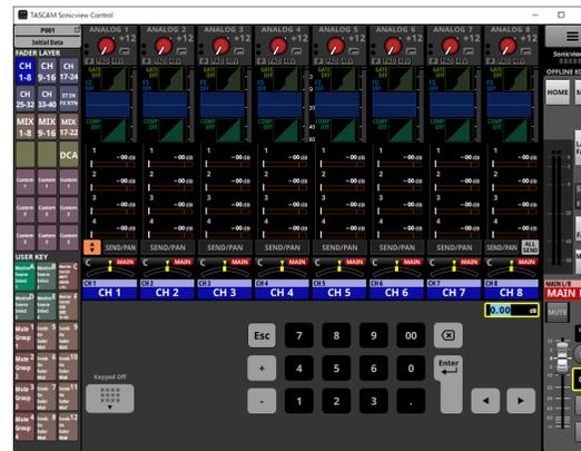
Le paramètre indiqué par le cadre jaune peut être réglé (voir « Procédure de réglage des paramètres » en page 12).
